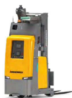
EKS 215a Mobil robot Rakodási alkalmazás Max. emelési magasság 6000 mm Teherbírás max. 1500 kg
