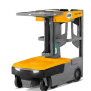
EKM 202 Darabárú kommissiózó targonca Kommissiózási magasság max. 5324 mm Teherbírás max. 215 kg
