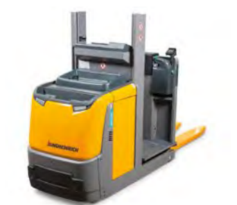
EKS 110 Elektromos vertikális kommissiózó targonca Kommissiózási magasság max. 4600 mm Teherbírás max. 1000 kg
